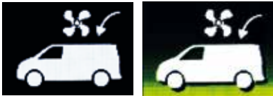
Kattotuuletin ulkoa sisään. Raikastaa sisäilmaa.
