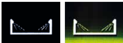
Lattia- tai ikkunalinjan epäsuora valaistus
