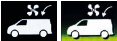
Kattotuuletin ulkoa sisään. Raikastaa sisäilmaa.
